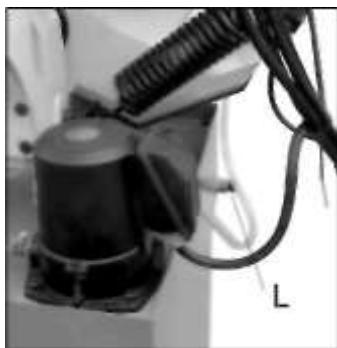
При помощи торцового ключа снимите заглушку (L) (не показана), чтобы слить хладагент.
