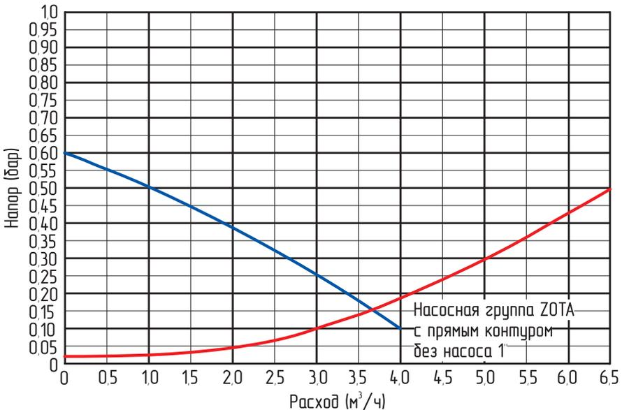
Рис.1 Гидравлические характеристики.
