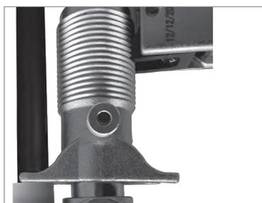
8. Проводите процесс запрессовки гильзы на фитинг до ее полного соединения с буртом фитинга. Рекомендуется избегать зазоров и несоосности соединения между фитингом и гильзой;
