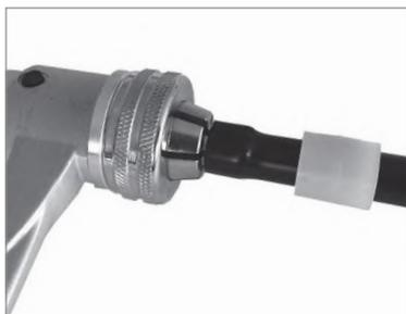
4. Проведите плавное экспандирование трубы PE-X в три этапа (30%, 70%, 100%), между этапами проворачивая экспандируемую трубу на 30 градусов вокруг своей оси;
