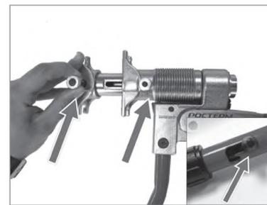
6. Переведите ручку тисков в верхнее положение, потяните вниз блокиратор чтобы разъединить рычаг и насадку на тиски, вытащите осевые болты, установите необходимую насадку на тиски, зафиксируйте осевой болт и верните в исходное положение блокиратор;
