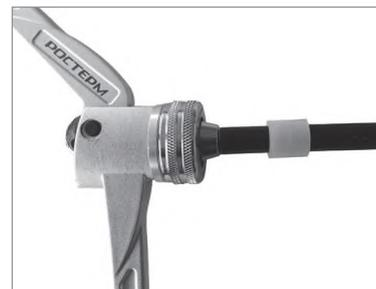
3. Вставьте наконечник насадки в трубу PE-X;
