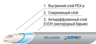
Трубы SANEXT «Универсальные» состоят из несущего слоя сшитого полиэтилена PEX-а натурального цвета (прозрачный) и антидиффузионного слоя EVOH серого цвета. Слои соединены между собой с помощью эластичного клея.
