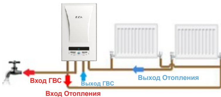
Рисунок 7. Схема Подключения Установки Монотермического Устройства.
