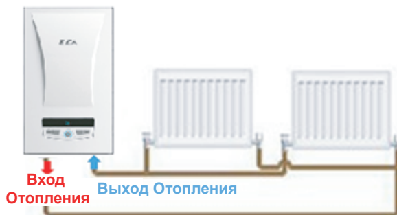
Рисунок 8. Схема подключения устройства СН
