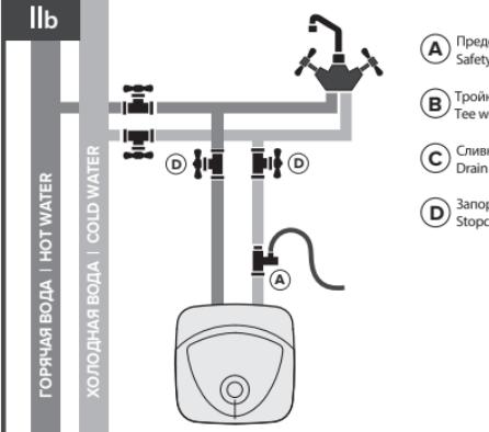
Ⓐ Предохранительный клапан
