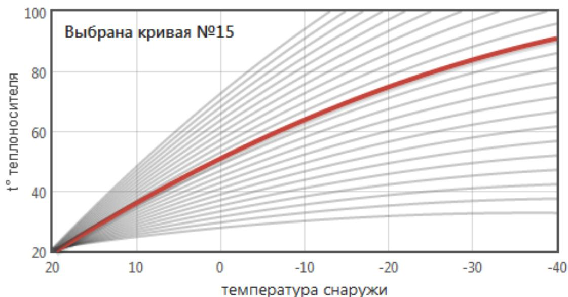
В основе режима лежит использование определенных кривых ПЗА - зависимостей температуры теплоносителя от температуры воздуха на улице.
