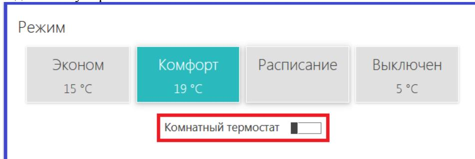
При включенном режиме «Комнатный термостат» управление работой котла выполняется по командам от комнатного терморегулятора.
