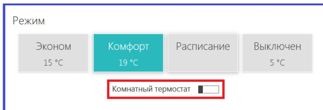
При включенном режиме «Комнатный термостат» управление работой котла выполняется по командам от выносного панели «Комфорт».
