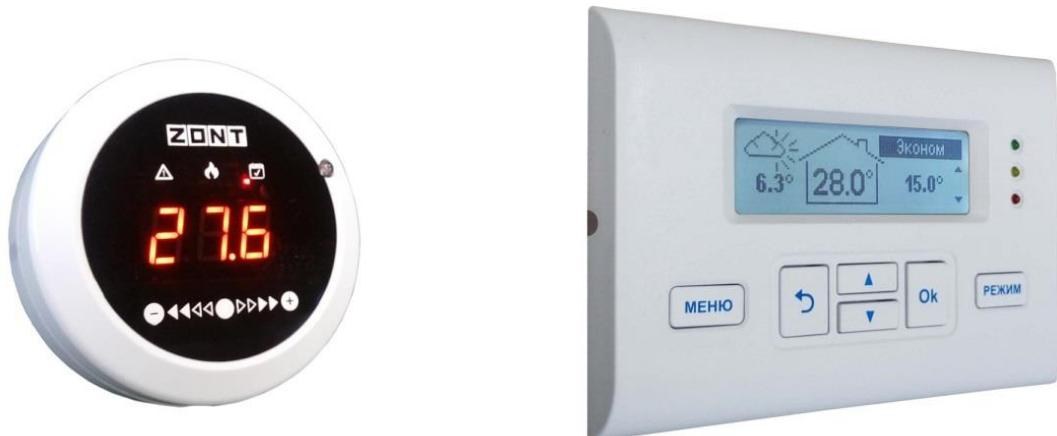
Чтобы Вход, к которому подключена панель управления, мог обрабатывать информацию, в Настройках терmostата нужно обязательно указать назначение для данного входа – «**ОТ-адаптер, радиомодуль или не используется**»:
