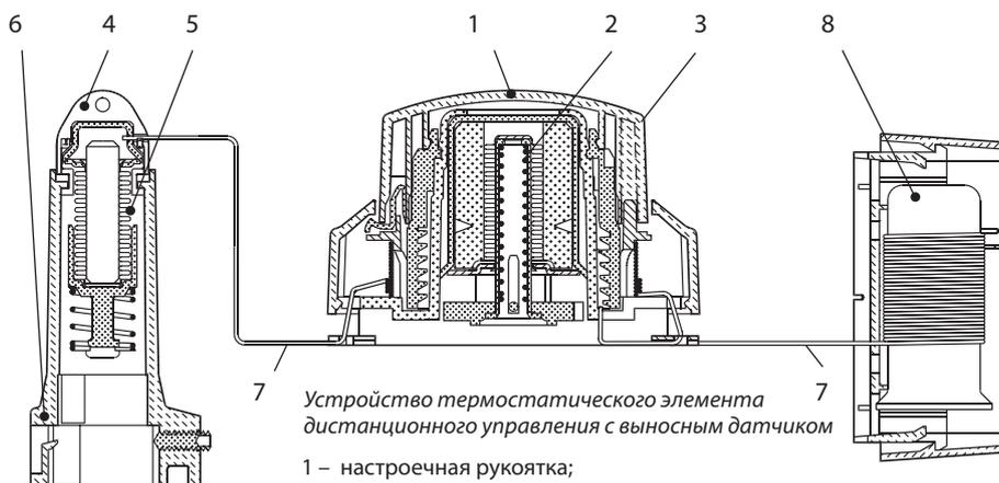
*Устройство термостатического элемента дистанционного управления с выносным датчиком*
