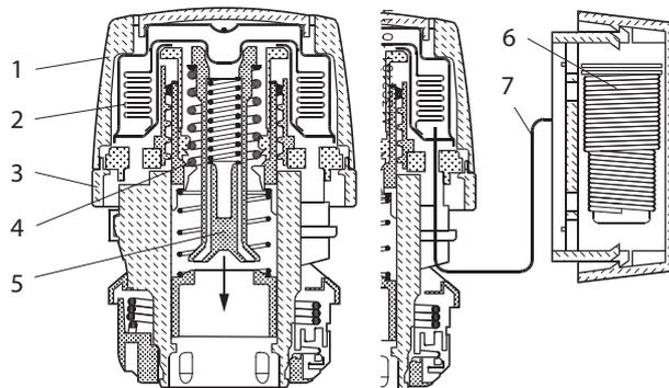
*Устройство термостатического элемента дистанционного управления со встроенным датчиком*
