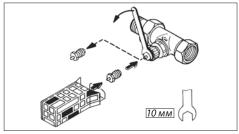
Адаптер для присоединения термостатических элементов RA 5062, RA 5065 и RA 5068 к клапанам терморегуляторов с установочной резьбой M30 × 1,5
