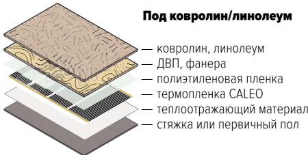
Рис. Схема монтажа теплого пола CALEO под ламинат, ковролин, линолеум
