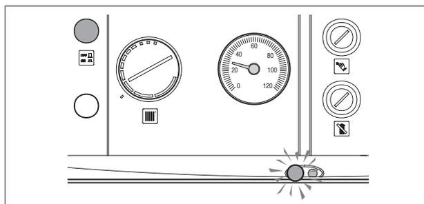
Если при запуске или работе котла произойдёт сбой, то котёл перейдёт в режим БЛОКировки, при этом зажигается красная лампочка на панели управления.
