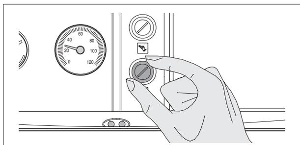
**!** Если датчик тяги срабатывает слишком часто, следует проверить, не засорился ли дымоход и правильно ли он изготовлен.
