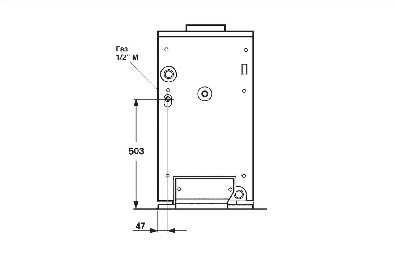
**!** Система подачи газа должна соответствовать мощности котла и иметь все предохранительные устройства, предусмотренные действующими нормами и правилами.
