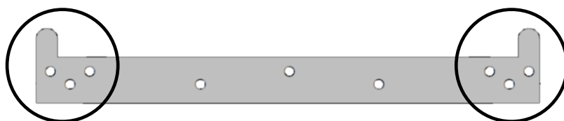
Рис. 12 Монтажная планка (кронштейн крепления котла на стене)
