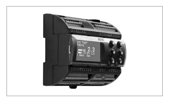
Модуль управления насосами PCM CWS PLUS — это микропроцессорный контроллер с предустановленным программным обеспечением, предназначенный для регулирования давления воды в системах холодного водоснабжения, горячего водоснабжения, отопления и т.д., с каскадным подключением до четырех насосов в одной насосной группе.
